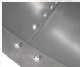
Закручивающийся винт с закручивающейся головкой, чтобы избежать засорения
