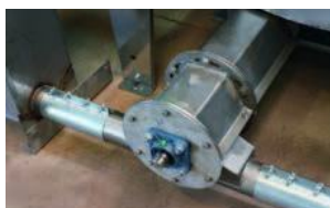
Специальный передаточный узел между разгрузочным шнеком дозатора и системой транспортировки по трубам DR 1500
