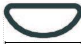
36mm Рычаг в разрезе
