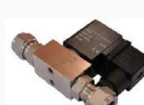
AMN 870 Электромагнитный клапан 400л/ч, 230В переменного тока, 2 режущих кольца AMN 360 + 2 x AMN 333
